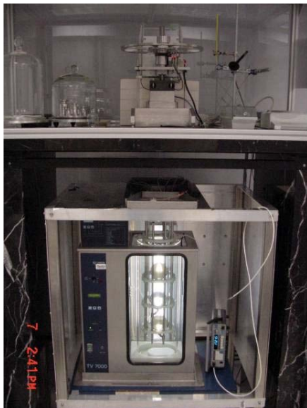
Fig. 1 Sistema de Pesada Hidrostática del Patrón Nacional de Densidad.
